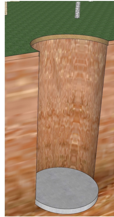
3. Pour Base Concrete
